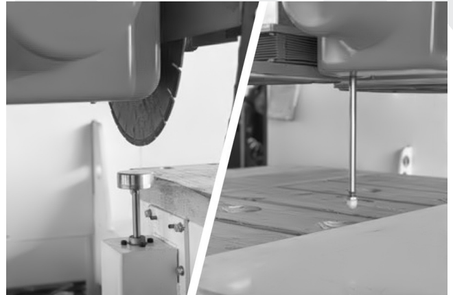
Messen der Scheibengröße und Messen der Plattendicke
